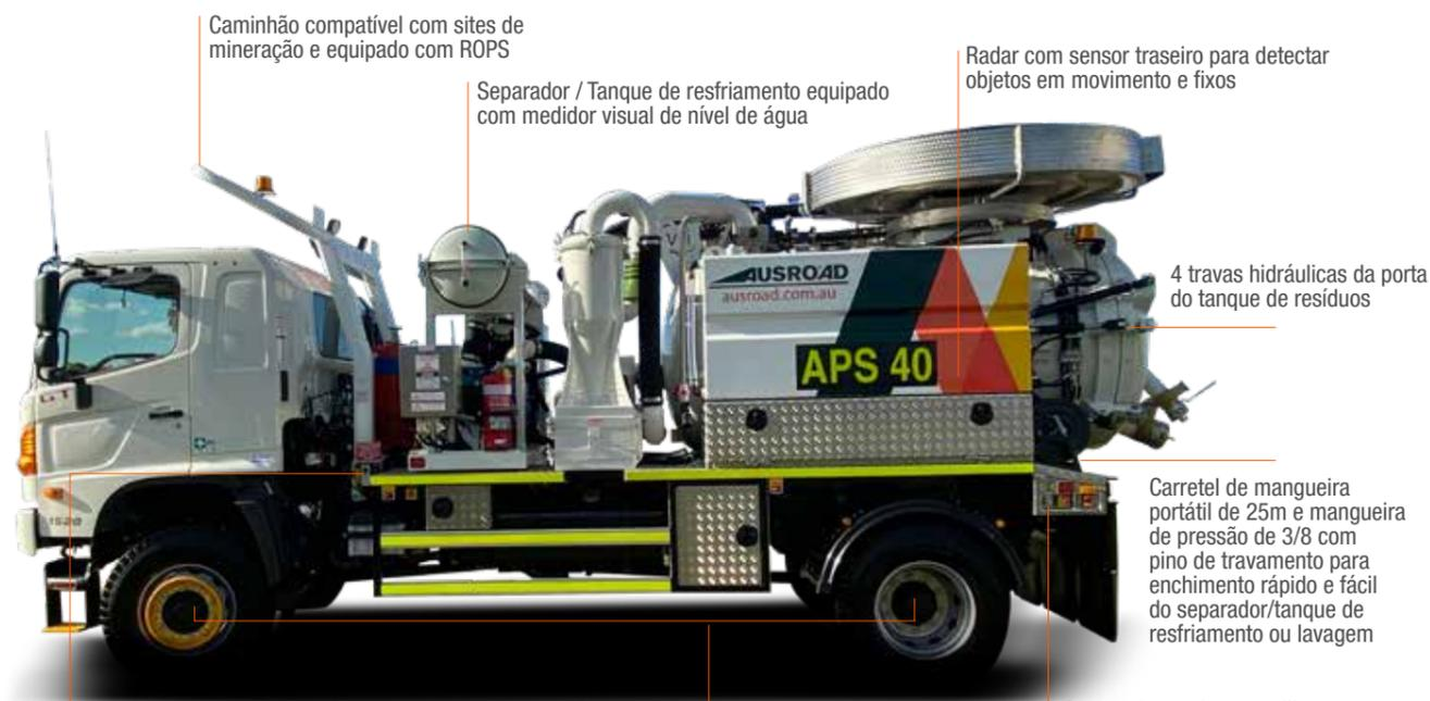
Caminhão compatível com sites de mineração e equipado com ROPS
