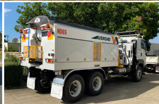
Diseñado para entregar asfalto o productos de cantera y es adecuado para una variedad de requisitos de mantenimiento de carreteras.
